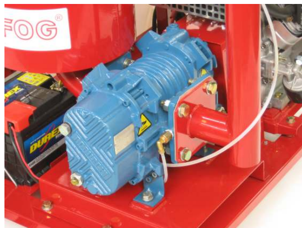
Detalhe do soprador do pulsFOG Super Pro
