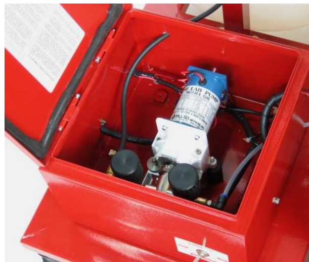
Detalhe da caixa da bomba FMI
