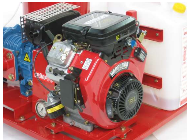
Motor Briggs&Stratton montado em subchassi.
